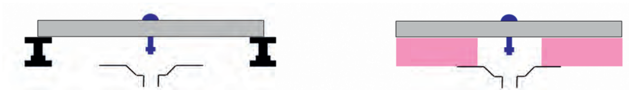
Fig. 3: esquema de baldosas con un pasador incorporado para permitir su elevación, inspección y posterior mantenimiento (dibujo izquierdo: para sistema sobre plots; dibujo derecho: sistema con aislante XPS integrado).
