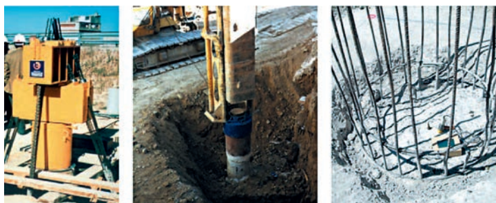
Figura 10: ensayo de prueba de carga, ensayo dinámico de carga y control de integridad por impedancia.
