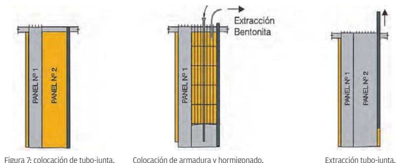
Figura 7: colocación de tubo-junta.
