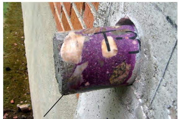
Figura 2: carbonatación del hormigón.
